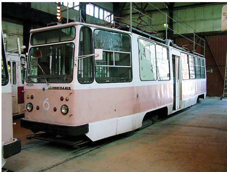
Ил. 5. Вагон марки ЛМ-68М («Ленинградец»), оснащенный двумя кабинами и дверью с левой стороны специально для однопутной трамвайной линии в Черемушках. Черемушки, 2004 г. < http://ymtram.mashke.org/russia/cheremushki/cherem_2_ru.html >
